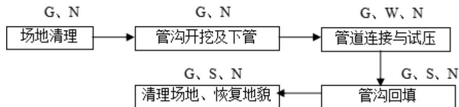
图 3.3-6 施工期油气集输工程工艺流程及排污节点图
