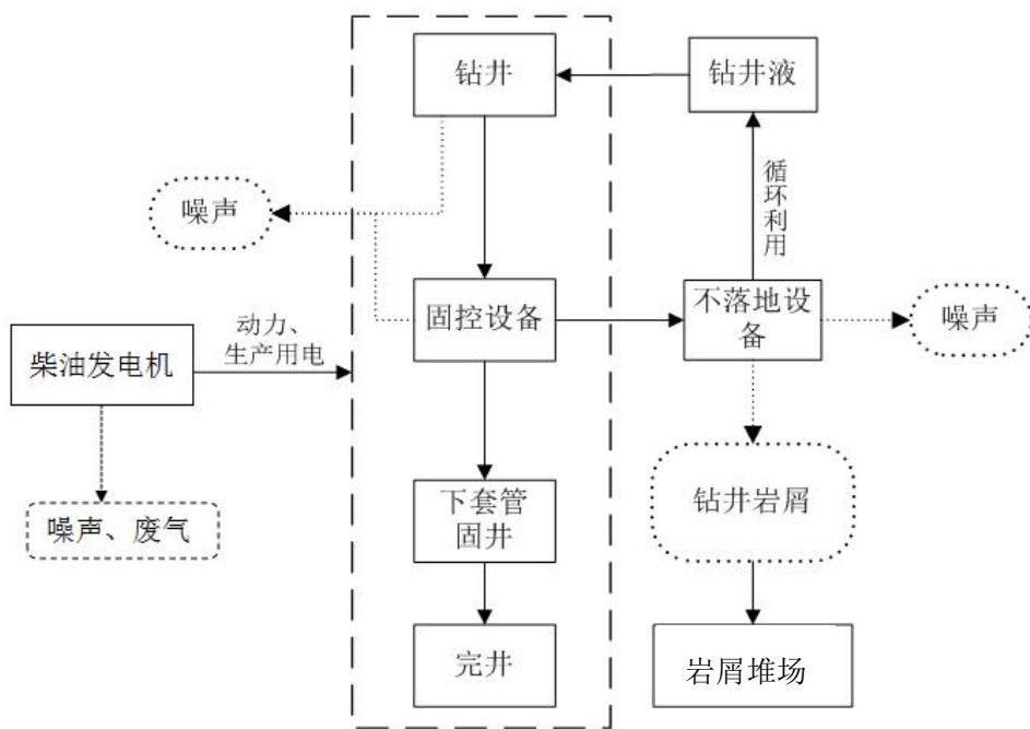
图 3.7-2 钻井工艺及产污节点图
