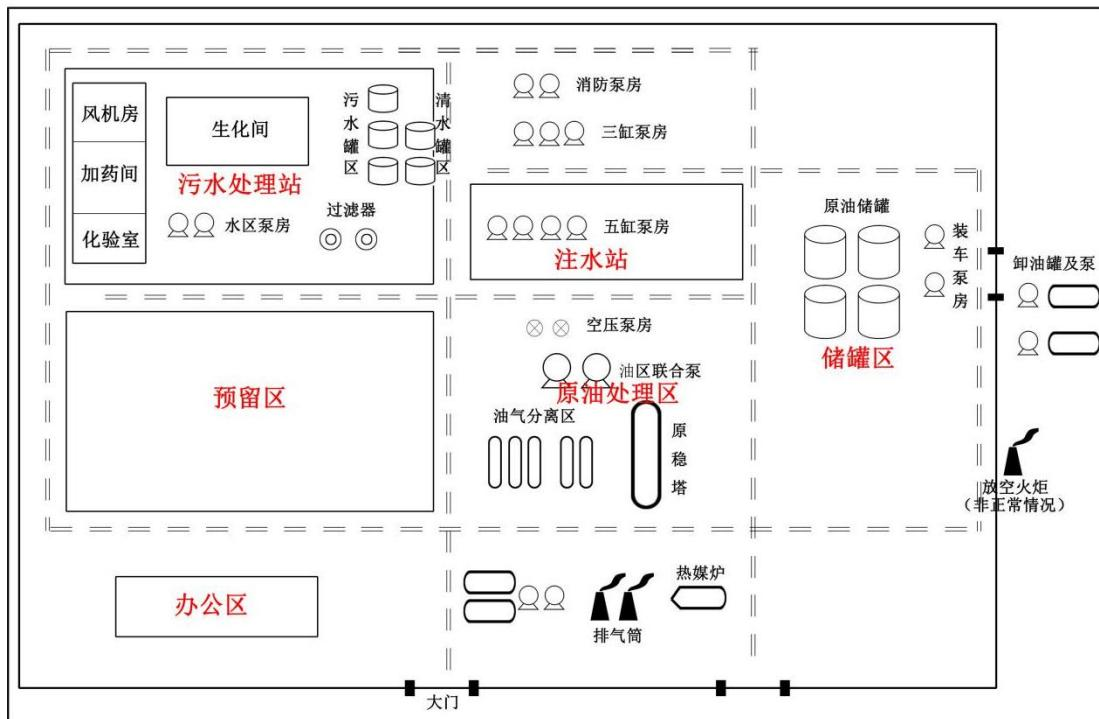
图 3.6-3 牛圈湖联合站平面布置图
