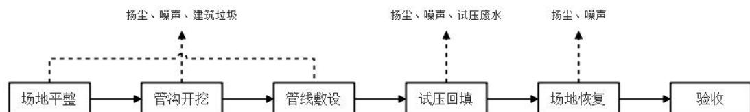
图 3.7-4 集输管线建设工艺流程及产污环节示意图
