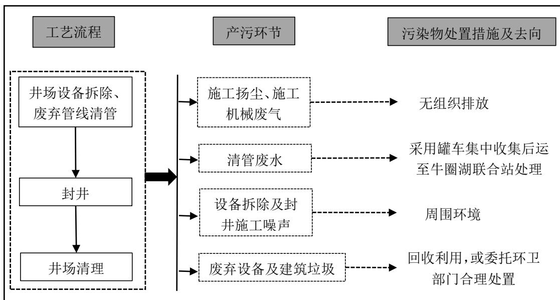
图 3.7-11 退役期工艺流程及产污环节示意图
