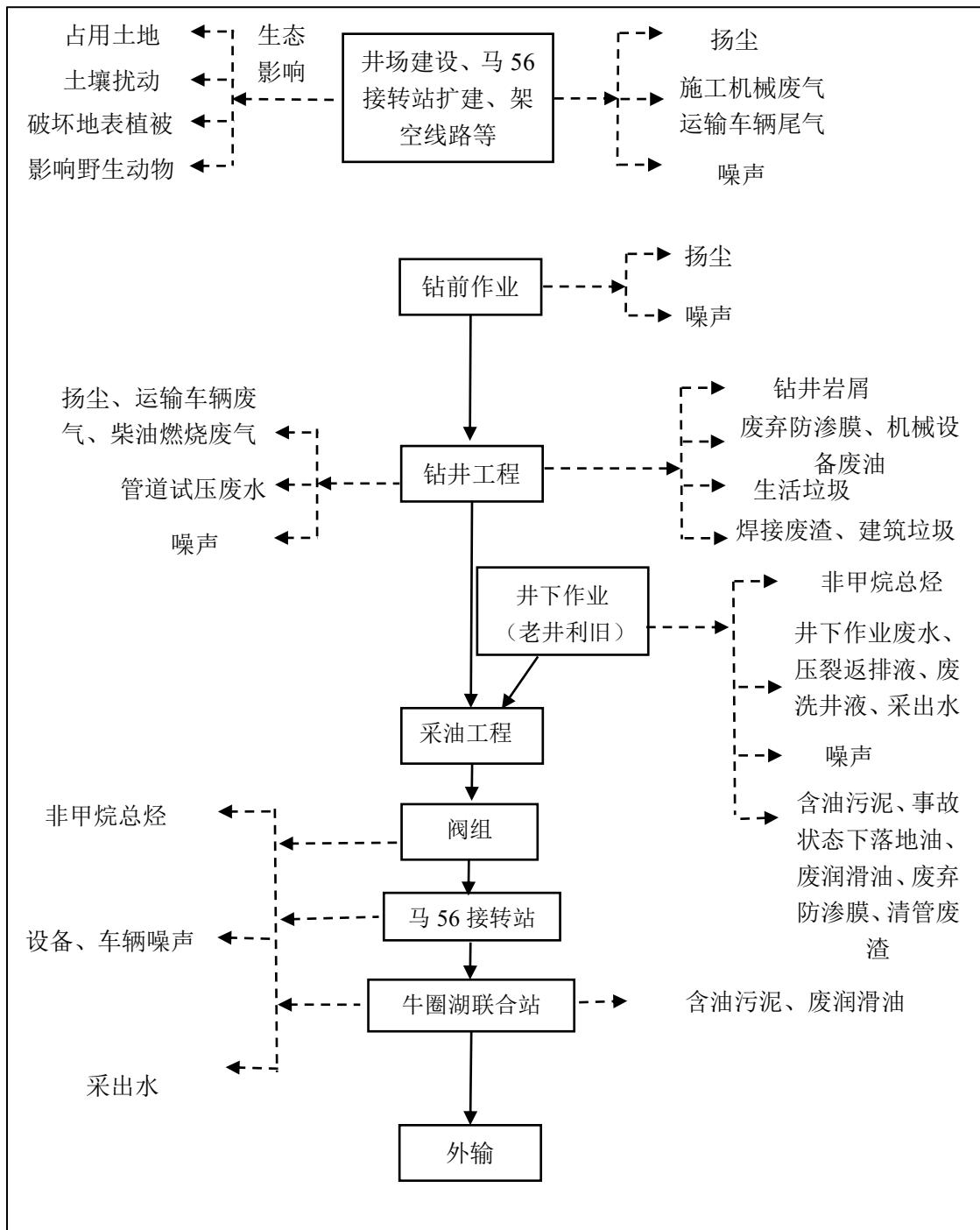
图 3.7-1 本项目工艺流程及产污节点图
