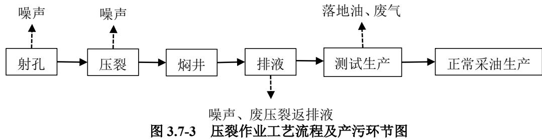
图 3.7-3 压裂作业工艺流程及产污环节图
