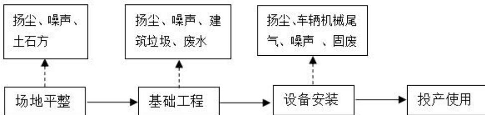
图 3.7-5 施工期工艺流程及产污环节图
