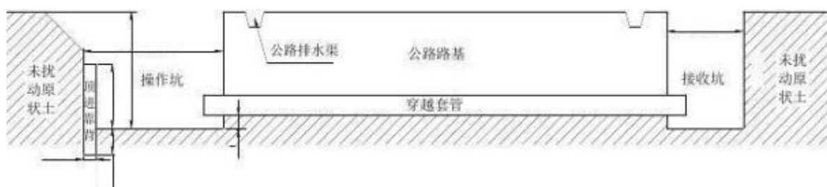
图 3.3-3 穿越道路施工作业示意图
