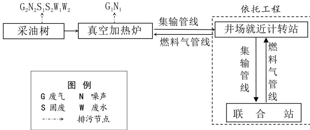
图 3.3-5 油气开采及集输工艺流程图
